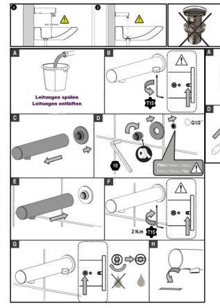
Wegen unterschiedlicher Wasserqualitäten ist die regelmäßige Überprüfung und Reinigung des Zugangsfilters und Perlators empfohlen. Ebenso sollten regelmäßig alle Anschlüße und Schraubverbindungen überprüft und nachgezogen werden.
